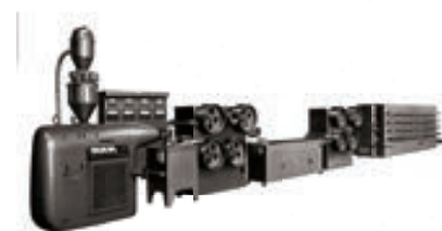
1960年代 ロープ、網の糸を製造する機械製造 網状構造テクノロジーの基礎技術
